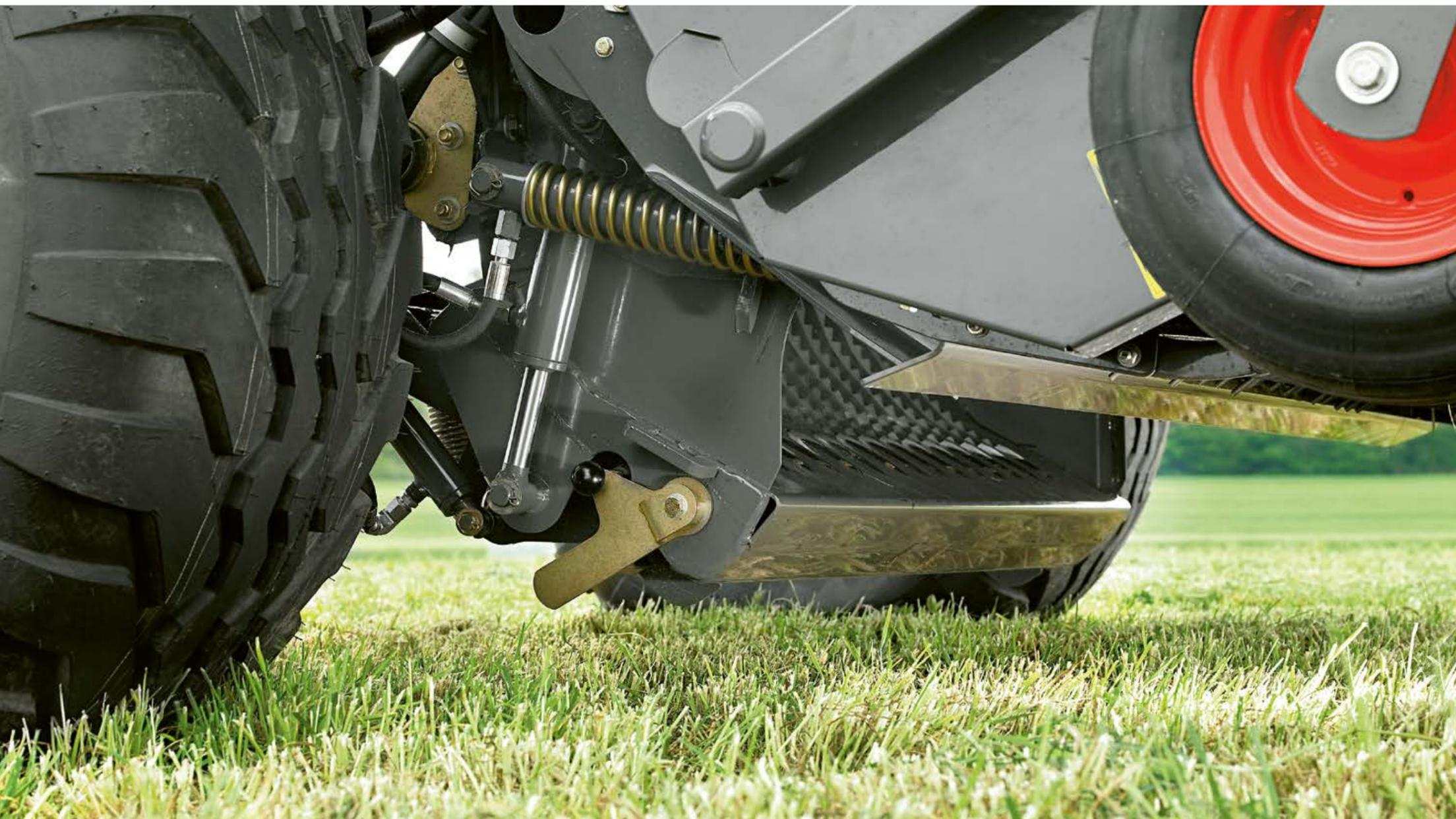
Ausgleichend: der hydraulisch absenkbare Boden PRO.
